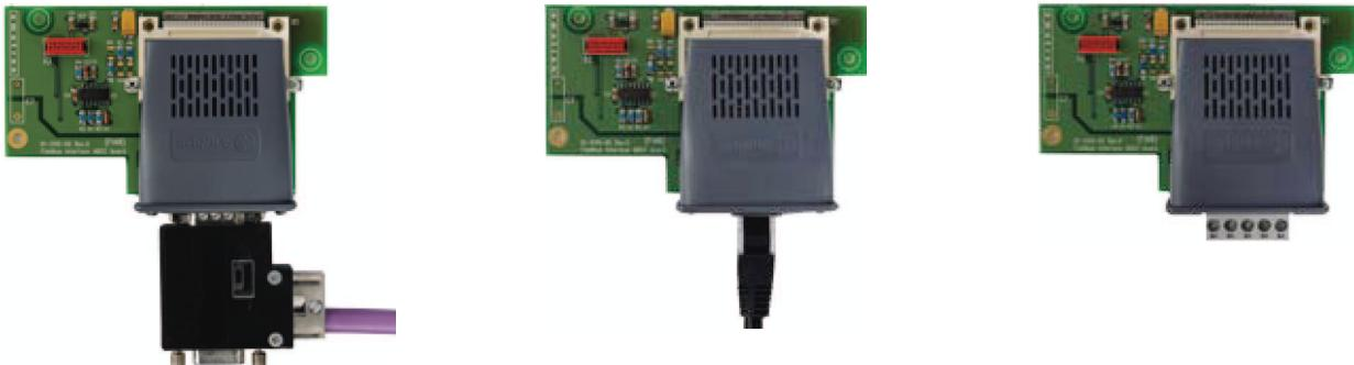
Je podporována komunikace po sběrnicích jako Profibus, DeviceNet a Ethernet, stejně jako analogová, digitální a sériová komunikace.
