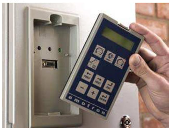
Odnímatelný ovládací panel má funkci kopírování, která vám umožní přenášet nastavení do dalších jednotek FDU.
