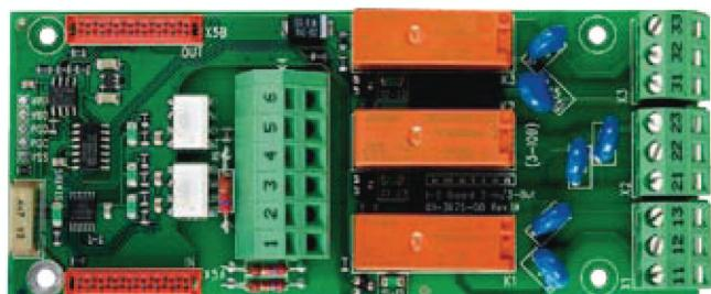
Kompaktní doplňkové desky se snadno instalují a umožňují kombinovat různé možnosti, např. sběrnicovou komunikaci, ochranu motoru a regulaci více čerpadel.
