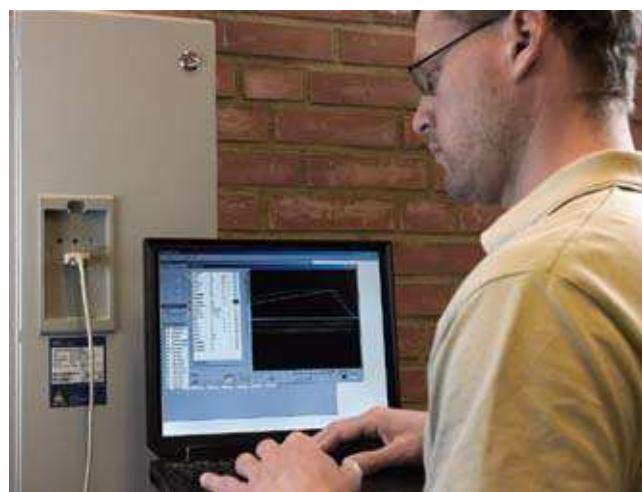
Po připojení kabelu RS232 přímo k přední straně se parametry snadno načtou do frekvenčního měniče Emotron. Funkce vyvinuté pro specifické aplikace, například regulaci čerpadel, umožňují rychlé a snadné nastavení pomocí softwaru EmoSoftCom.
