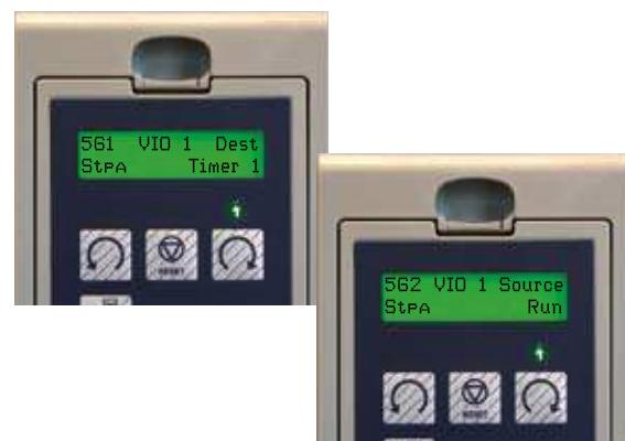
Emotron FDU podporuje virtuální spojování logických funkcí, komparátorů a časovačů. Pomocí ovládacího panelu lze snadno nastavovat cíl a zdroj virtuálního spojení.
